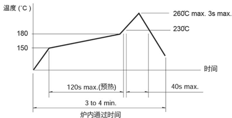
(1) 上述条件,为印刷电路板的零部品表面的温度。根据电路板的材质,大小,厚度等,电路板温度和开关表面温度会有很大的不同,关于开关表面温度,也请在上述条件下使用。
