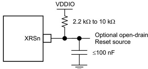
Figure 6-9. Reset Circuit
