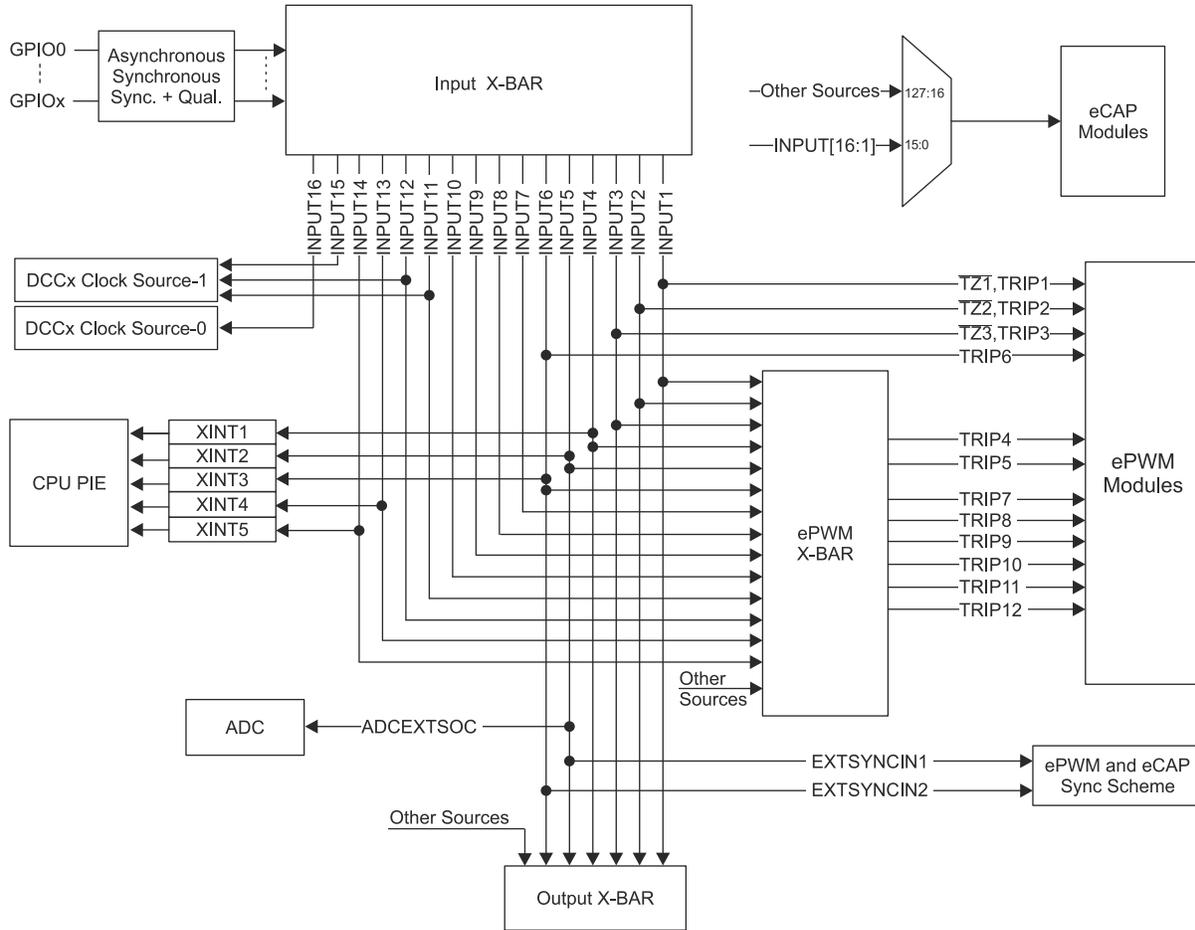
**Figure 5-6. Input X-BAR**
