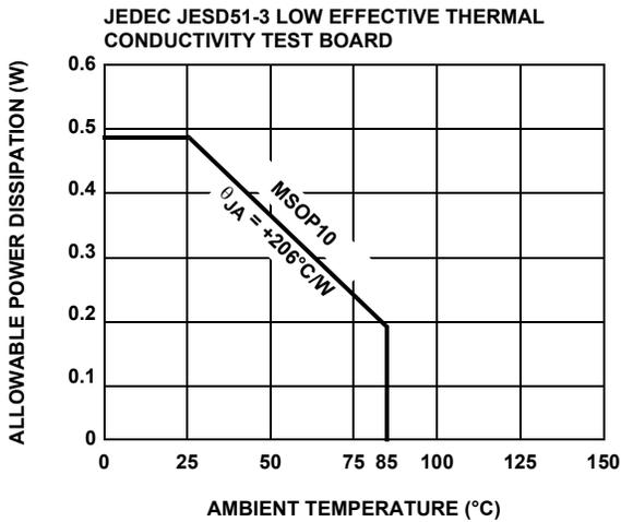
FIGURE 3. PACKAGE POWER DISSIPATION vs AMBIENT TEMPERATURE
