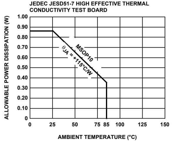
FIGURE 4. PACKAGE POWER DISSIPATION vs AMBIENT TEMPERATURE
