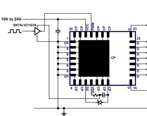
Fig. 26. 3.3 V PWM input buffer circuit
