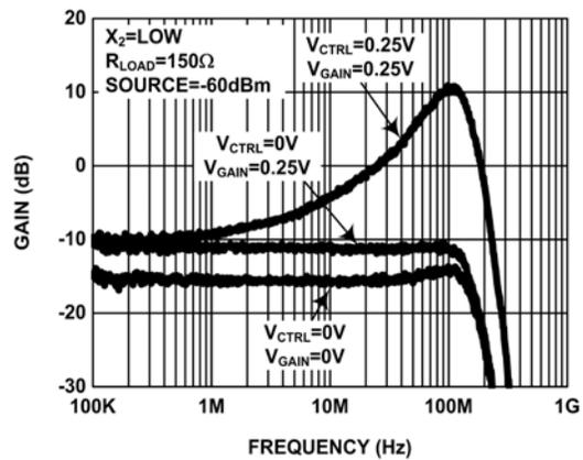
FIGURE 4. GAIN vs FREQUENCY FOR VARIOUS V<sub>CTRL</sub> AND V<sub>GAIN</sub>
