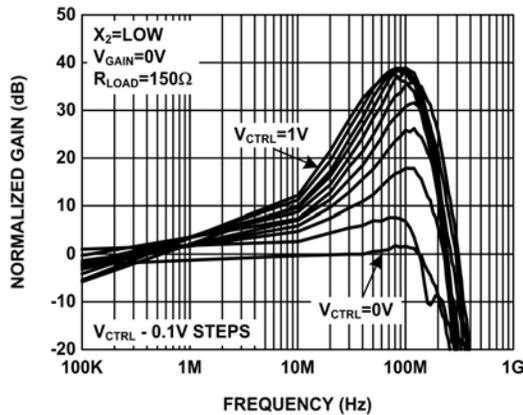
FIGURE 3. GAIN vs FREQUENCY FOR VARIOUS V<sub>CTRL</sub>
