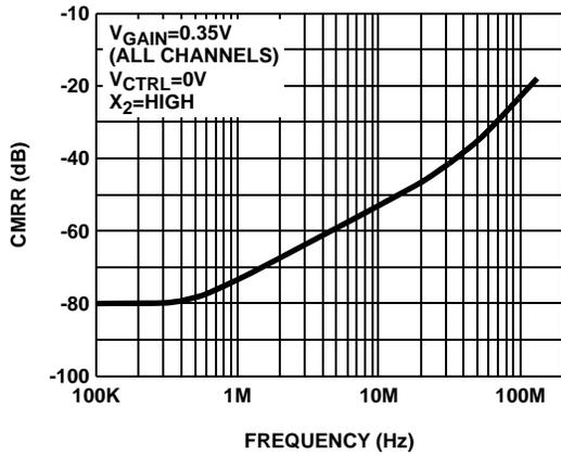
FIGURE 11. COMMON-MODE REJECTION
