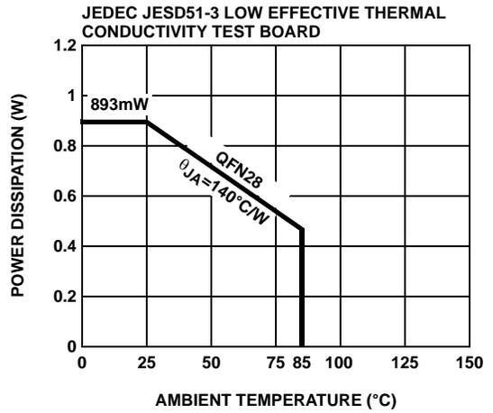
FIGURE 24. PACKAGE POWER DISSIPATION vs AMBIENT TEMPERATURE
