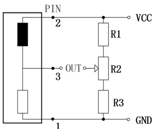
传感器主要由催化元件（黑元件）和补偿元件（白元件）组成，黑、白两个元件被安装到电桥中，通过可变电阻可调整电桥输出稳定的基准信号。当环境中存在氢气气体时，在催化元件表面会发生燃烧，元件表面温度上升，导致元件电阻增加，电桥失衡，通过电路采集电桥的输出电压。
