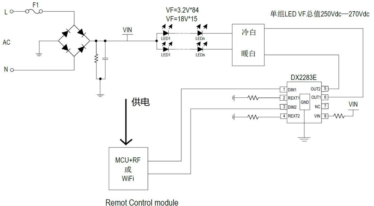
系统增加遥控控制电路可实现智能遥控灯的应用，控制电路的两路 PWM 信号通过对芯片的 DIM1 和 DIM2 端口控制，调节系统两路输出电流。遥控电路的控制部分可采用典型无线射频或蓝牙电路，通过遥控器或智能手机 APP 应用对智能灯进行控制。
