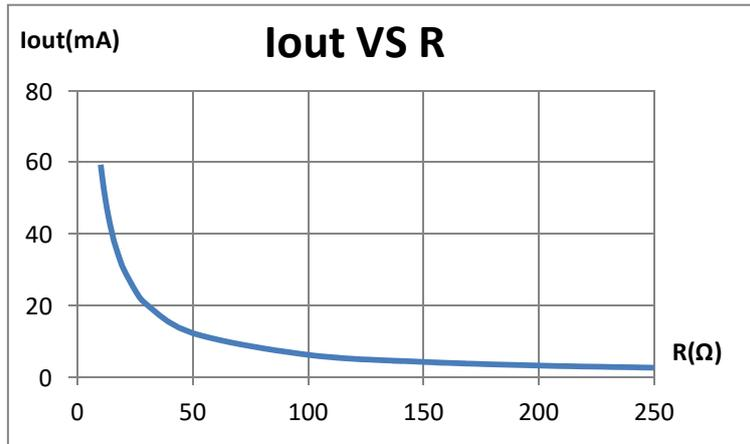
图 1. DX2283E 输出电流与 REXT 端口电阻关系曲线图
