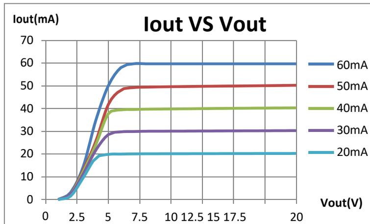
图 2. DX2283E 恒流曲线图
