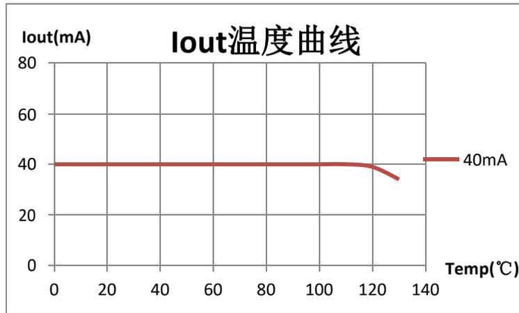
图 3. DX2283E 输出电流温度特性 (注 7)
