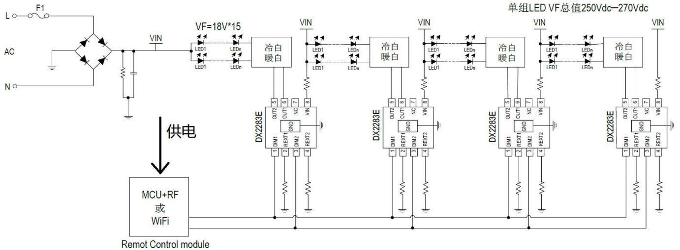
此方案同单颗 DX2283E 典型系统应用方案一的控制方式一样，通过“并联”的方式，可以使系统的功率增加。每颗 DX2283E 的 DIM 端口接收控制电路输出的 PWM 信号调节系统电流，单路 LED 灯组最大电流：
