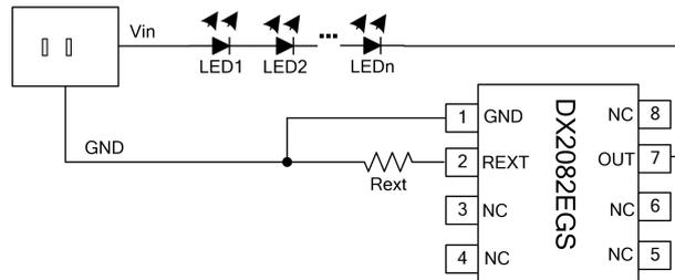
图 4. DX2082EGS 应用电路原理图
