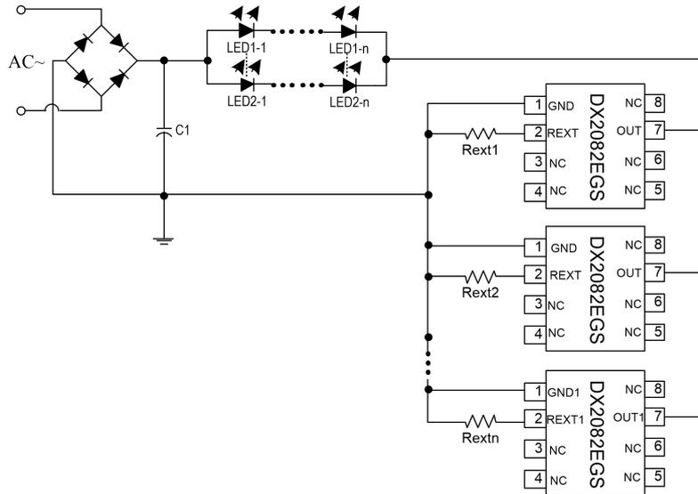
图 6. DX2082EGS 并联应用电路原理图
