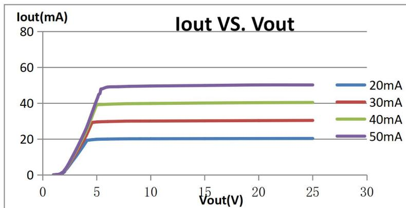
图 2. DX2082EGS 恒流曲线图
