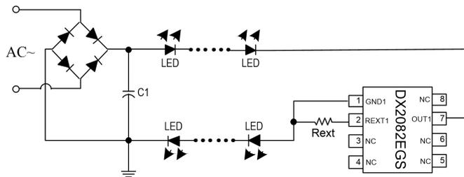
图 7. DX2082EGS 串接 LED 灯管中
