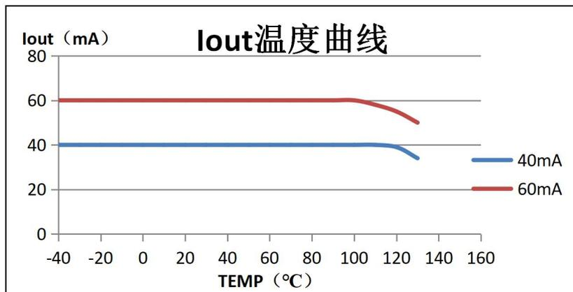
图 3. DX2082EGS 输出电流温度特性
