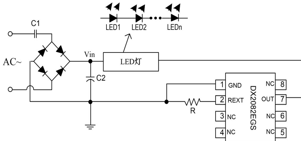
图 5 DX2082EGS 典型应用电路—交流电源输入
