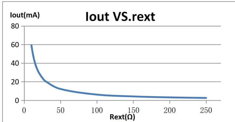
图 1. DX2082EGS 输出电流与 r<sub>ext</sub> 电阻关系曲线
