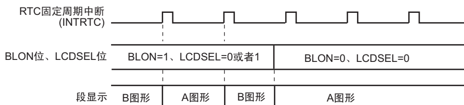
图 13-17 从闪烁显示到 A 图形显示的切换运行
