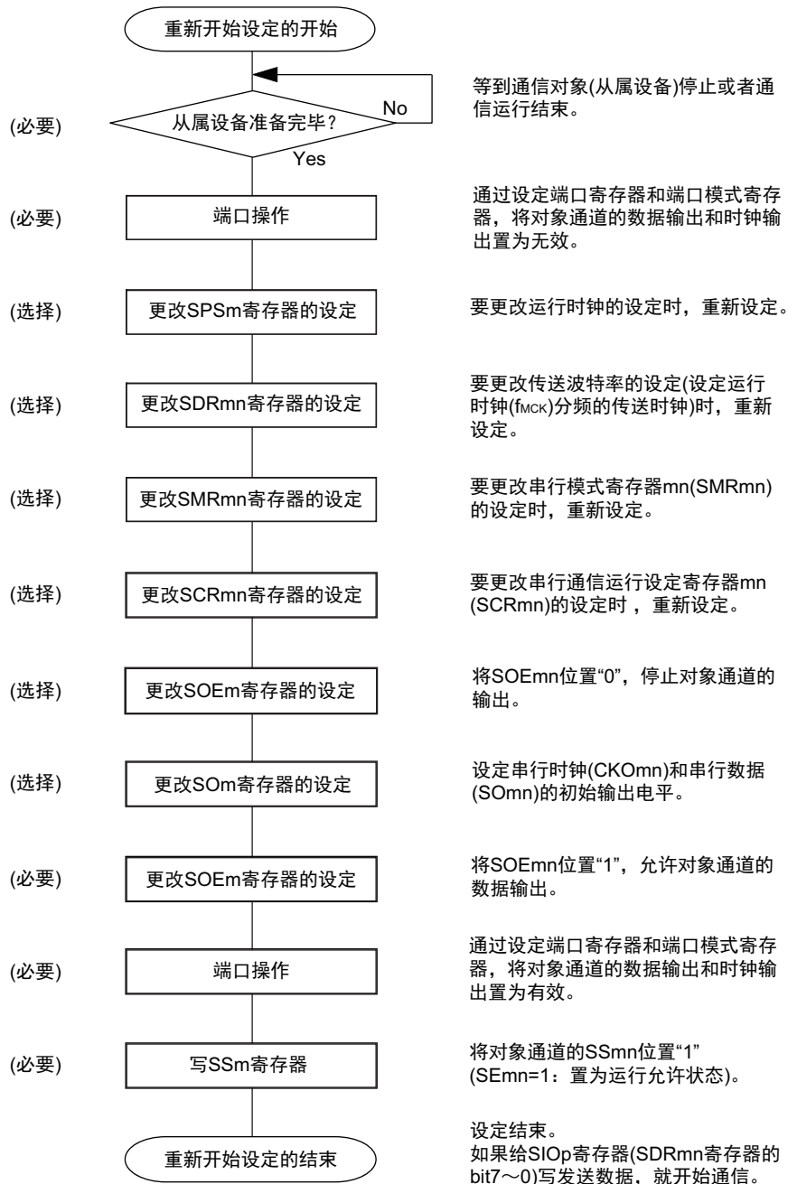
图 12-25 主控发送的重新开始设定步骤
