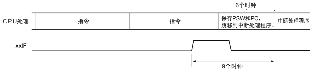
图 14-8 中断请求的接受时序（最短时间）
