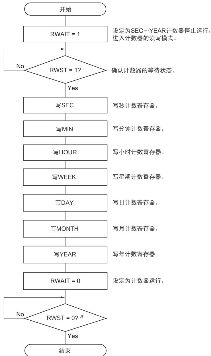
图 7-22 实时时钟计数器的写操作步骤
