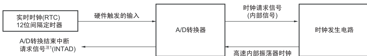
图 11-28 使用 SNOOZE 模式功能时的框图
