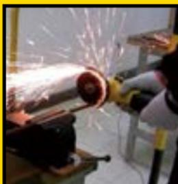
1 切割钢筋, 打磨铝合金焊缝
