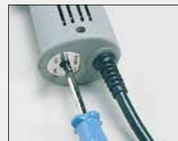
$250^{\circ}\text{C}$  -  $450^{\circ}\text{C}$  温度自由设定。
