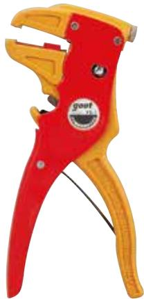
●配有固定剥线长度定子。(2—20mm 范围内能调整。) ●根据电线保护层厚度,利用刻度盘简单调节剪切深度。●本体材料为钢条与强化尼龙玻璃纤维,制品经久耐用。
