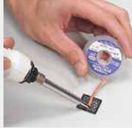
1. 用电烙铁和吸锡线清除 BGA 上的锡。
