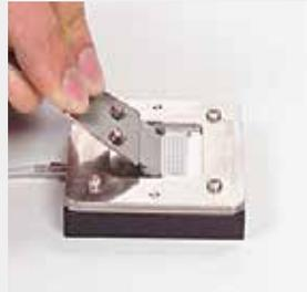
3. 盖上金属膜板框, 刮刷焊锡膏
