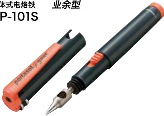
●小型轻巧、气体燃气型烙铁。快热、点火 30 秒后即可使用。通过调整旋钮，实现功率 10—60W 相当的温度控制（焊嘴温度最高 480°C 时）。※使用前，请充气。（另售）
