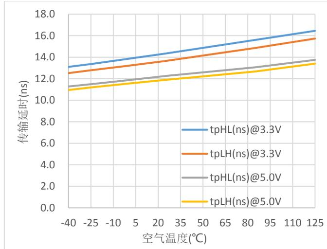
图 10.π16x6x 传输延时 vs. 空气温度
