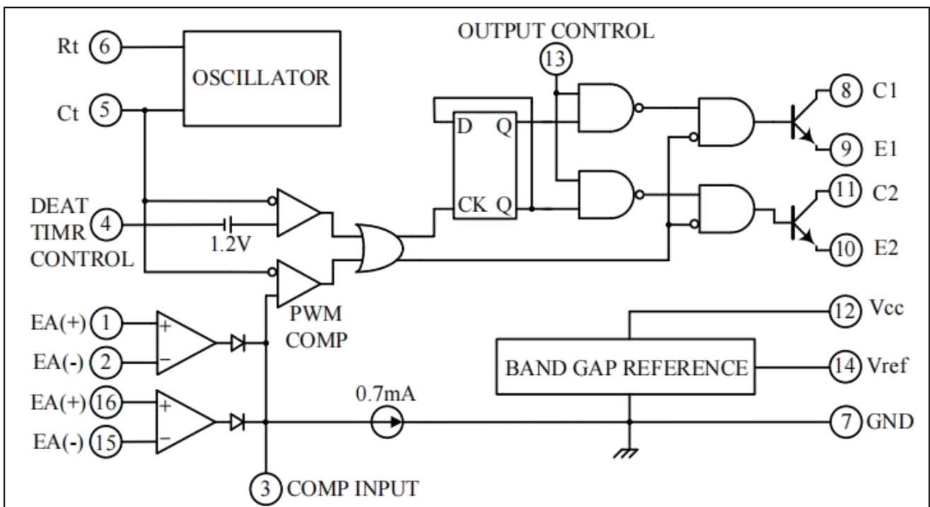
图 1 KA7500B 原理图
