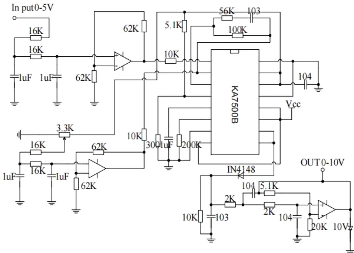
图 10 开关电源控制电路典型应用图
