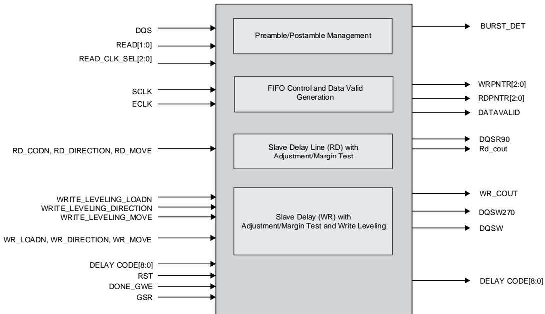
**Figure 2.26. DQS Control and Delay Block (DQSBUF)**
