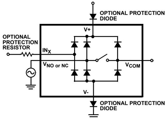
FIGURE 8. OVERVOLTAGE PROTECTION
