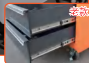
导轨和轨道，由原卡点安装升级为铆接安装，抽屉固定更加牢固、顺滑；6、7、8抽工具车，底层的抽屉升级为双导轨，承重能力提升50%以上；
