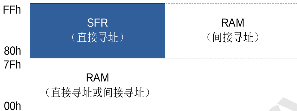
内部 256 bytes RAM 结构图
