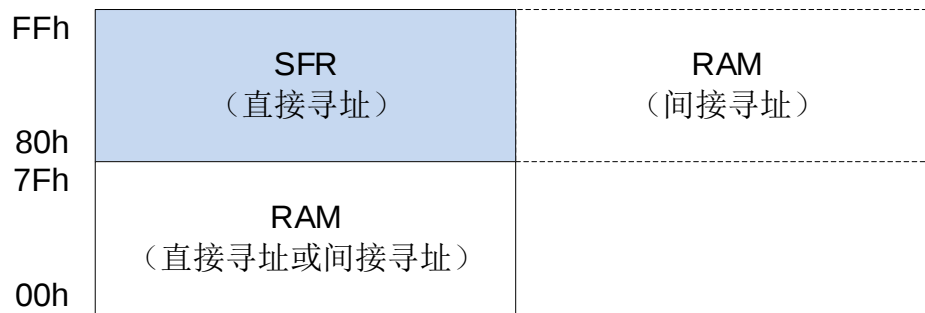
内部 256 bytes RAM 结构图
