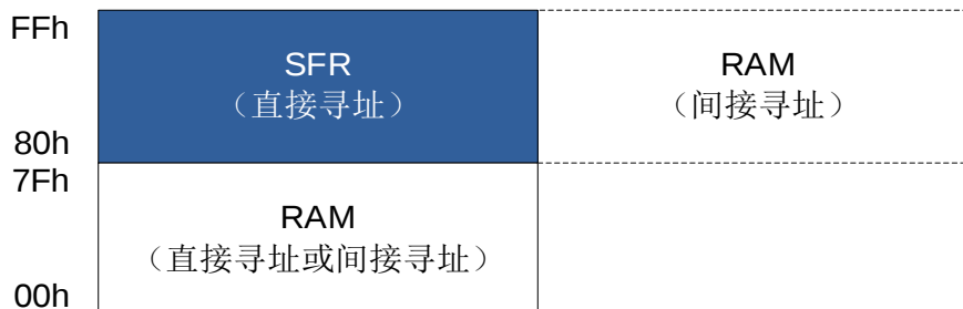
内部 256 bytes RAM 结构图
