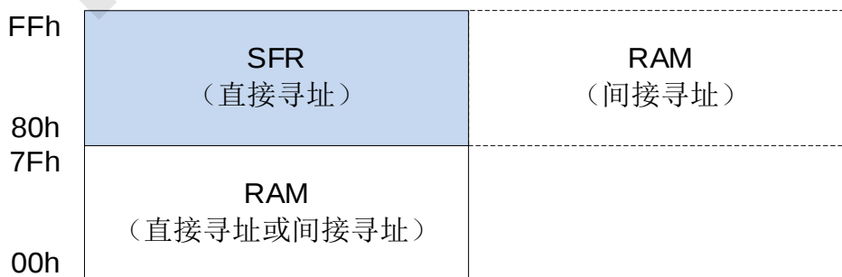
内部 256 bytes RAM 结构图
