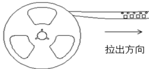
图 31 13寸编带拉出方向
