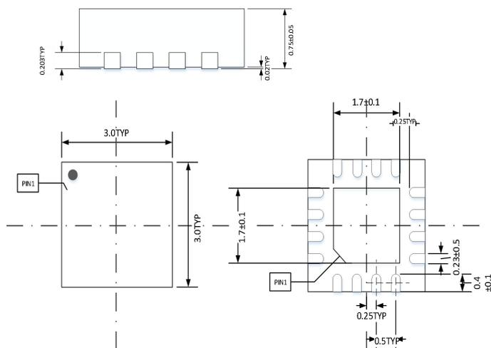
图4-2. QFN3x3-16L封装尺寸图
