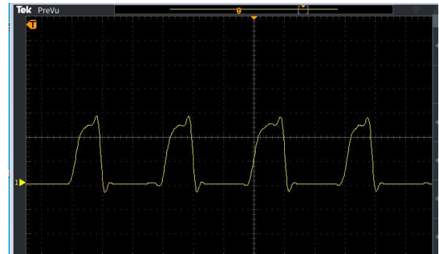
R1=10 kΩ 上拉电阻 C2= 680pF 10kHz 开关磁场
