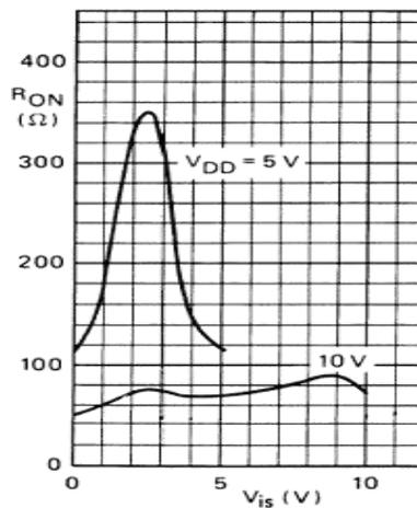
图 2 导通电阻是输入电压的函数 ( $I_{is}=200\mu A$   $V_{SS}=V_{EE}=0V$ )
