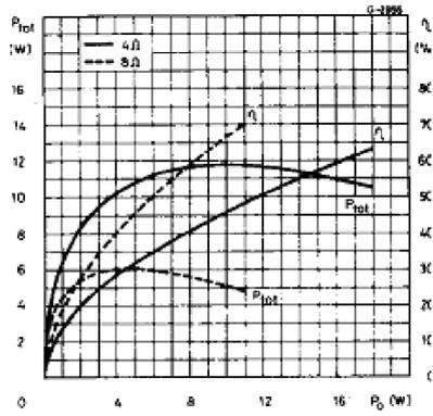
图 12 最大功率耗散 VS 输出功率
