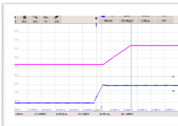
图 16. 12V 转 1.2V, I_{LOAD}=0A , 启动波形 C1: RUN 波形, C2: V_{OUT} 波形
