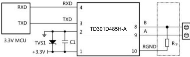
图 2.MCU 3.3V 供电应用电路
