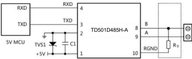
图 1.MCU 5V供电应用电路
