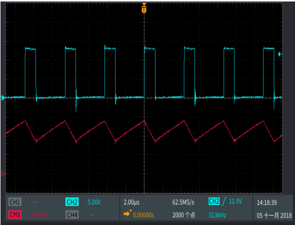
SW 脚与电感电流工作波形
