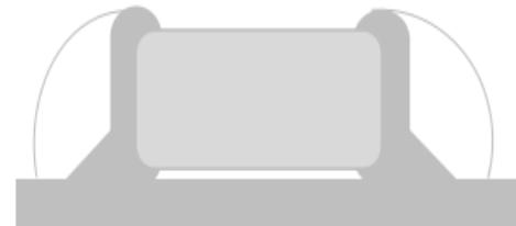
B. 焊料太少固定力量不足，可能会引起电容芯片与线路接触不良。
