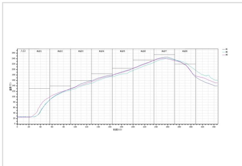
注：以上所有温度是指在封装本体焊点表面测得的温度。
