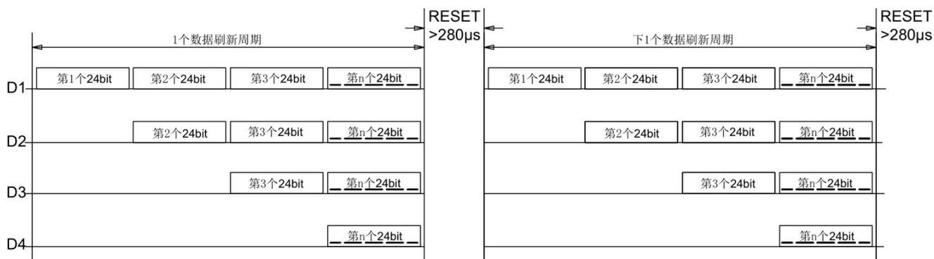
注：其中 D1 为 MCU 端发送的数据，D2、D3、D4 为级联电路自动整形转发的数据。
