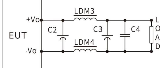
对纹波&噪声要求一般时，外围推荐仅使用 C2、C5 即可；对纹波&噪声要求严格时；推荐使用上图电路。
