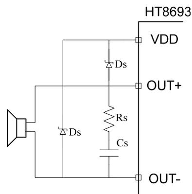
图表 2 输出端的连接
