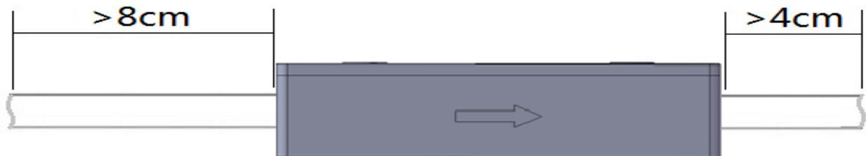
注意安装时气流方向与传感器气流指示方向一致，传感器引出线按照定义对应正确连接后，再接通电源开始工作。
