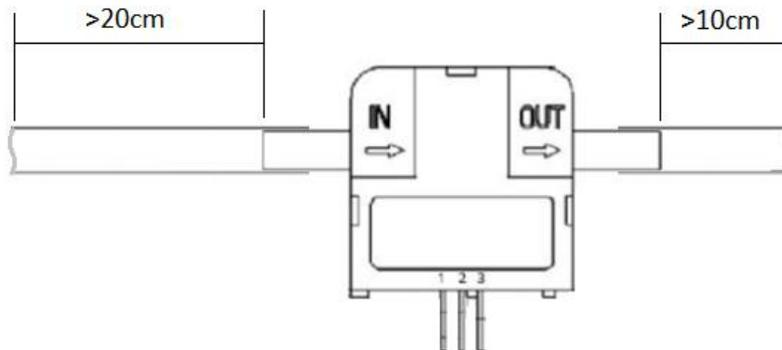
注意安装时气流方向与传感器气流指示方向一致，传感器引出线按照定义对应正确连接后，再接通电源开始工作。
