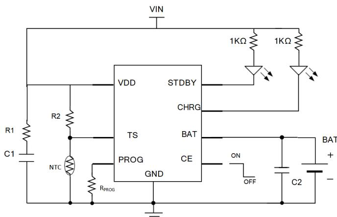
注 1：建议取值（ $R1=4.7\text{--}10\Omega$ ,  $C1/C2$  为  $1\text{--}10\mu\text{F}$ ）
