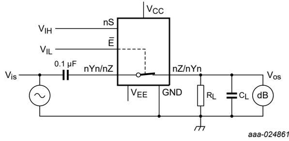
$V_{CC} = 4.5\text{ V}$ ;  $GND = 0\text{ V}$ ;  $V_{EE} = -4.5\text{ V}$ ;  $R_L = 600\ \Omega$ ;  $R_S = 1\text{ k}\Omega$ .
