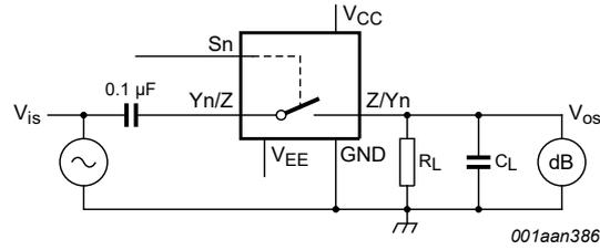
$V_{CC} = 4.5\text{ V}$ ;  $GND = 0\text{ V}$ ;  $V_{EE} = -4.5\text{ V}$ ;  $R_L = 600\ \Omega$ ;  $R_S = 1\text{ k}\Omega$
