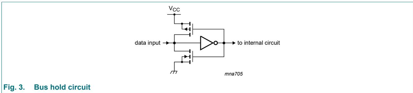
Fig. 3. Bus hold circuit
