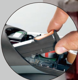
增加便利 充电电池和传感器可自行更换，充电电池可持续使用6小时以上，传感器无需校准
