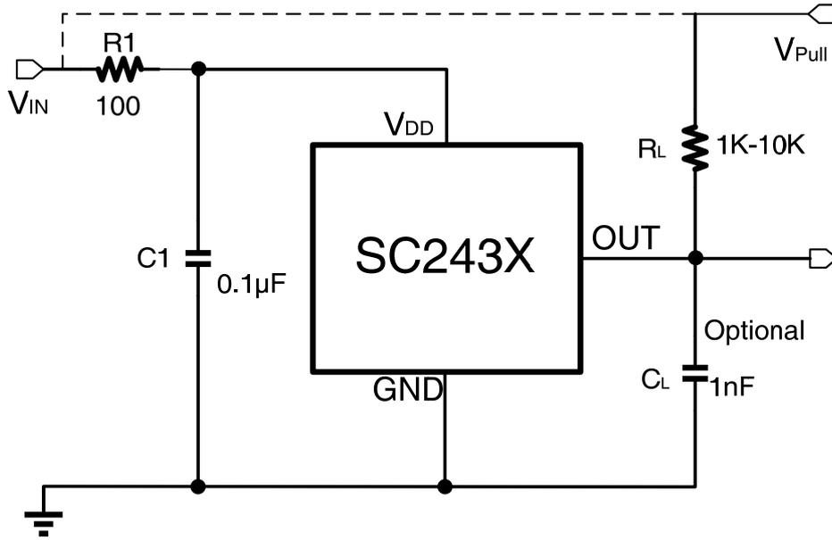
SC243X 内部有电压调节器，可以在宽供电电压范围内工作。当器件工作于非稳压电源供电的应用时，必须在外部添加瞬态保护。对于使用稳压电源线路供电的应用，可能仍然需要 EMI/RFI 保护。强烈建议电源端与接地端使用外接电容，可降低外部噪声及内部斩波频率技术产生的噪声，建议靠近芯片  $V_{DD}$  电源端并联  $C_1$  电容到地，其典型值为  $0.1\mu\text{F}$ 。同时在外部可选配串联电阻  $R_1$  其典型值为  $100\Omega$ 。输出电容  $C_L$  用作输出滤波，典型值为  $1\text{nF}$ 。
