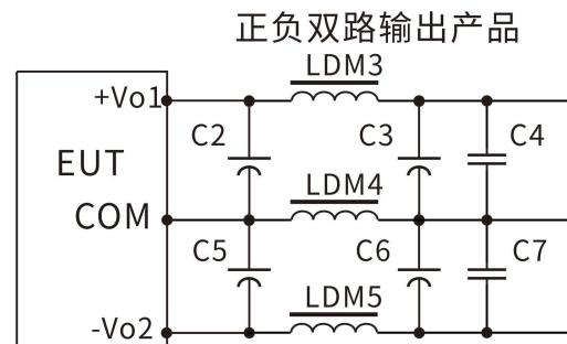
对纹波&噪声要求一般时, 外围推荐仅使用 C2、C5 即可; 对纹波&噪声要求严格时; 推荐使用上图电路。
