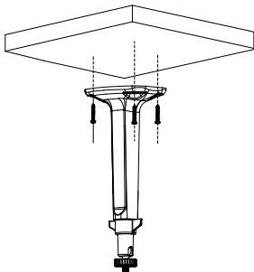
② 完成支架固定安装，将摄像机安装到万向头上，并接好线。
