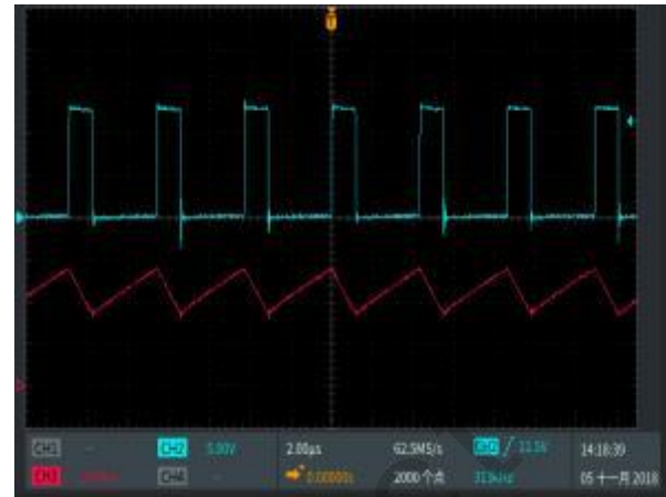
SW 脚与电感电流工作波形
