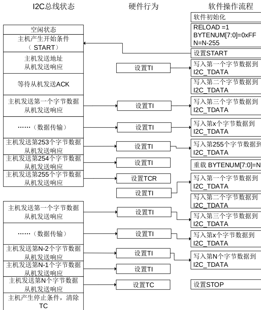
图 21-19. I2C 主机发送编程模型 (N&gt;255)
