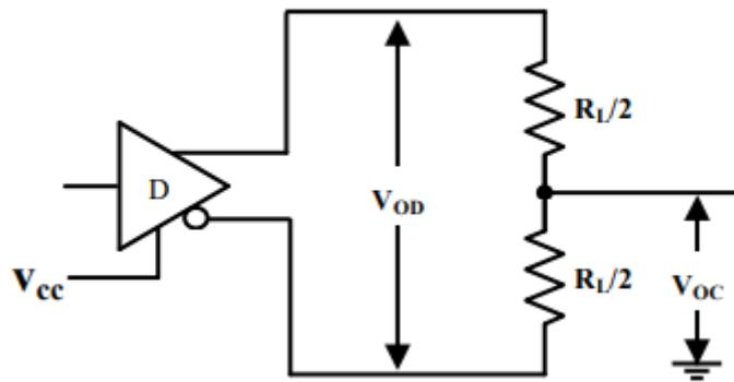
图 2 驱动器直流测试负载
