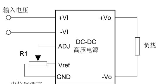
R1=10KΩ 可调电阻, Vref=7.5VDC, 控制电压0~5VDC
