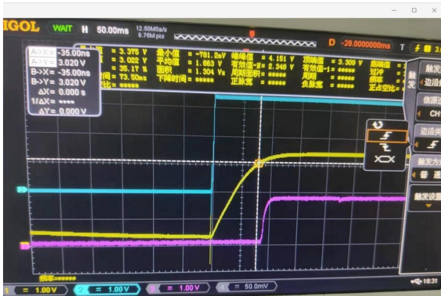
图一 DVDD33 Resetb HP_L Power on sequence
