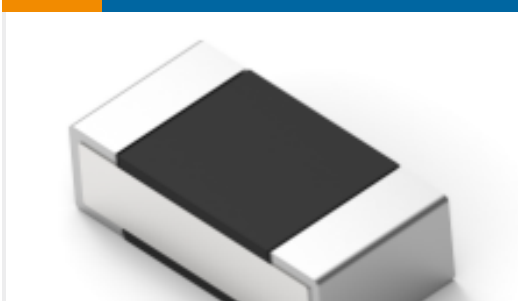
TE Part #2-2176306-3 RP 1E 0.1W 1K96 0.1% 25PPM 5K RL
