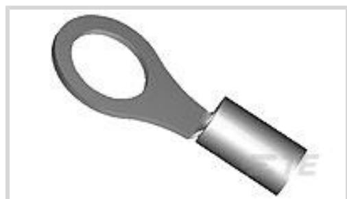
Ring Terminal Product Type: **Closed Ring Tongue Terminal**Wire Size: **21 mm<sup>2</sup>**Stud Size: **M12**Stud Diameter: **13 mm [.512 in]**
