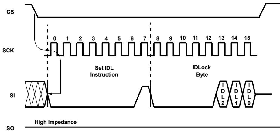
FIGURE 25. EEPROM IDLock (SET IDL) OPERATION SEQUENCE
