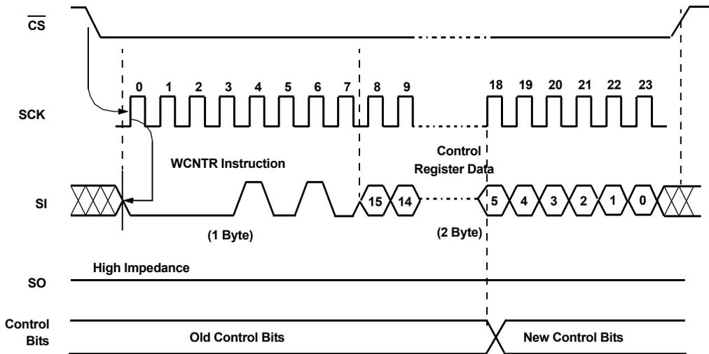
FIGURE 23. WRITE CONTROL REGISTER (WCNTR) OPERATION SEQUENCE
