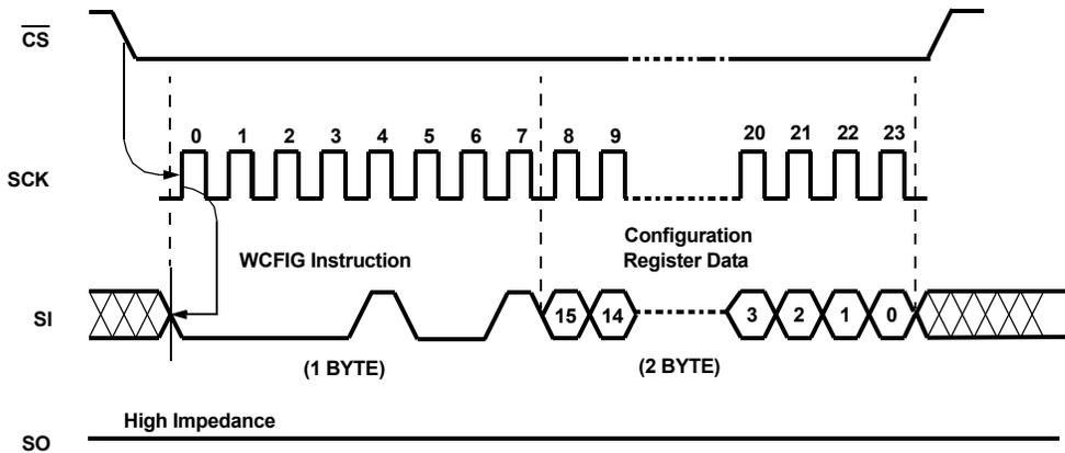
FIGURE 22. WRITE CONFIGURATION REGISTER (WCFIG) OPERATION SEQUENCE
