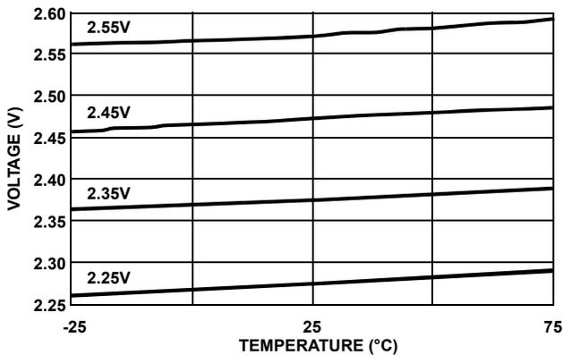
FIGURE 5. OVER DISCHARGE TRIP VOLTAGE (TYPICAL)
