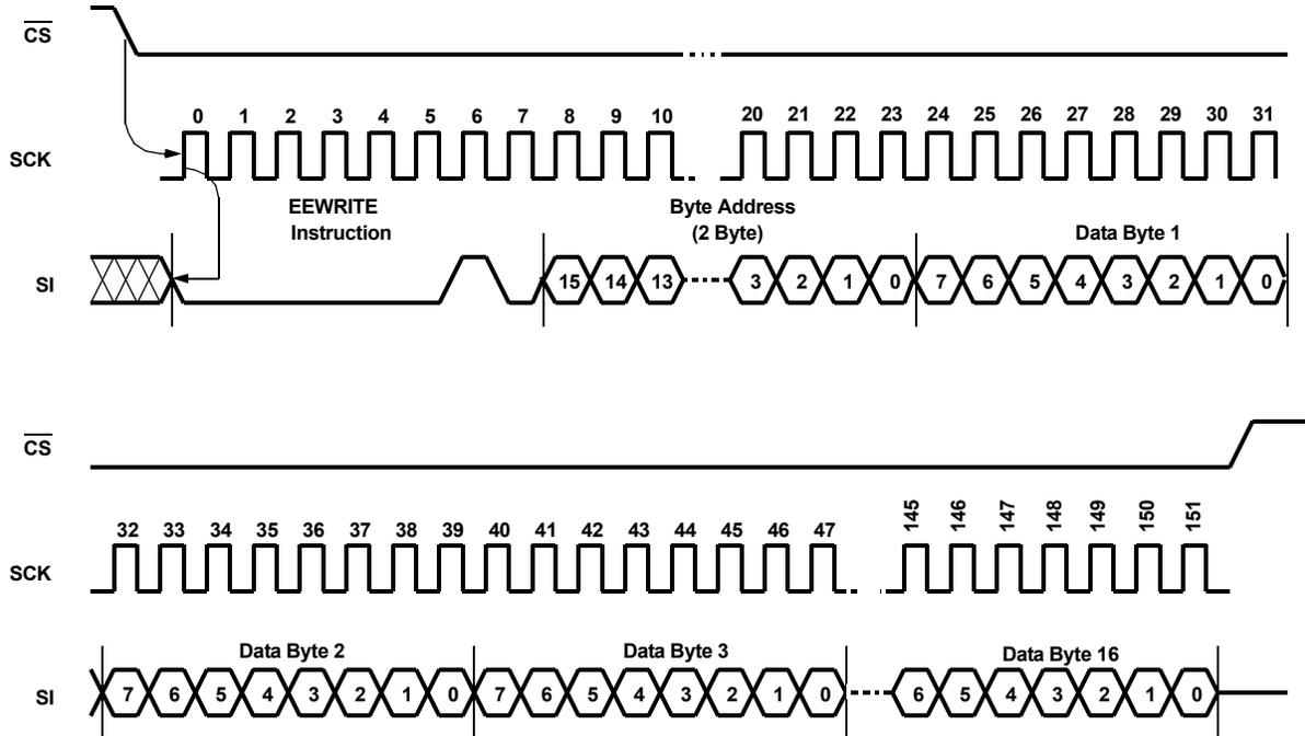
FIGURE 19. EEPROM PAGE WRITE (EERWRITE) OPERATION SEQUENCE
