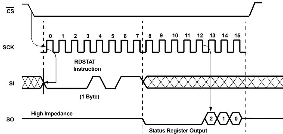
FIGURE 24. READ STATUS REGISTER (RDSTAT) OPERATION SEQUENCE
